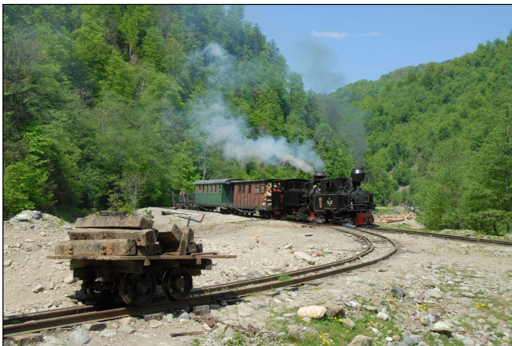
Gravitační drezína pro údržbu dráhy na rumunské lesní železnici Viseu de Sus
