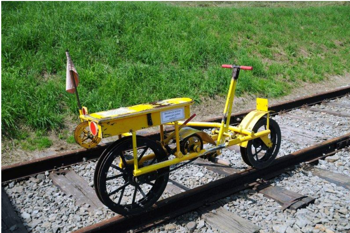
Replika pákové drezíny vycházející z původní konstrukce Karla Fridricha Draise
