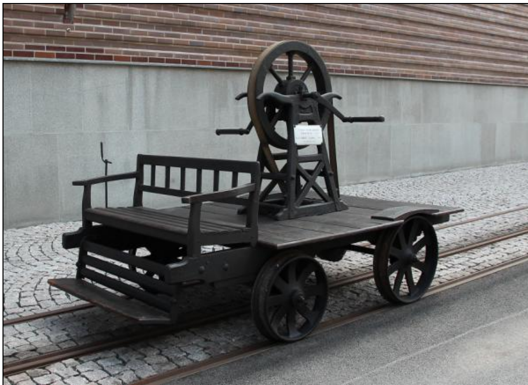
Drezína se setrvačником a pohonem plochým řemenem ze sbírek NTM v Praze
